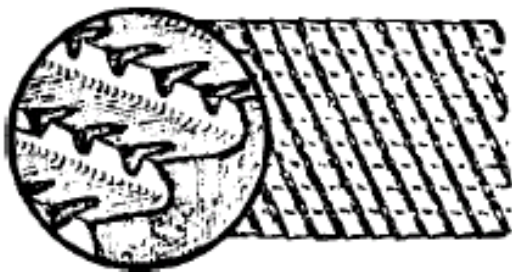
lima fresada com ranhuras para quebrar o cavaco
